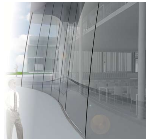
Fassade mit kaltgekrümmten Glas: ITKE Thiemo
