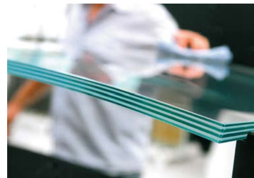
Forschungsthema: Kaltverformtes Glas, laminiert von Sedak, Gersthofen Glas
